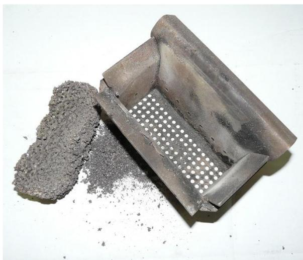
**Os intervalos de limpeza do depósito de pellets e do cinzeiro, dependem da quantidade de pellets que se utiliza.**
