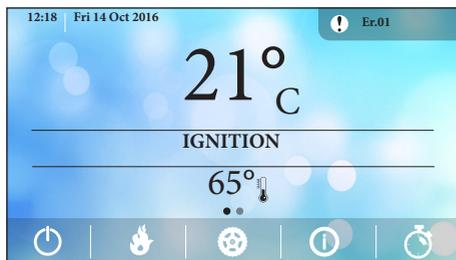
O erro de bloqueio ou não bloqueio está marcado com **!** e o código de erro correspondente. Quando clicada, a janela de erro é aberta.
