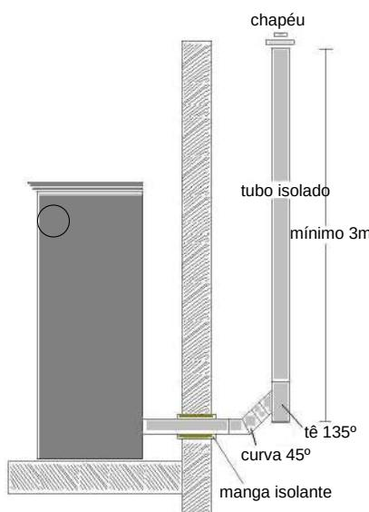
Instalação interior pelo telhado
