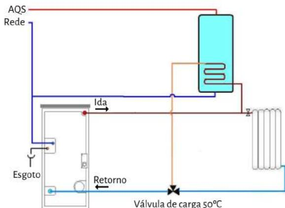
**Instalação hidráulica com Acumulador para A.Q.S. e Válvula de 3 vias eléctrica**
