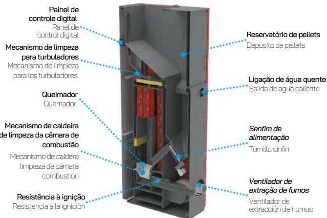
Inclui controlo electrónico com painel digital e teclado intuitivo, ignição automática, relógio para funcionamento automático, supervisão do equipamento eléctrico com mensagens de alarme por código de erro, controlo automático da combustão em função da temperatura ambiente e temperatura desejada.
