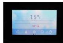
Control electrónico com painel táctil de ultima geração, com ignição automática (programação diária ou semanal), relógio para funcionamento automático, supervisão do equipamento eléctrico com mensagens de alarme por código de erro, controlo automático da combustão em função da temperatura ambiente e temperatura desejada.
