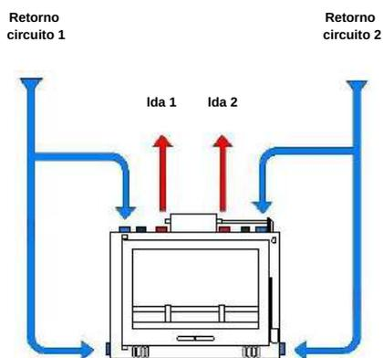
2 - Circuito hidráulico para Aquecimento Central e águas quentes sanitárias com válvula 3 vias.
